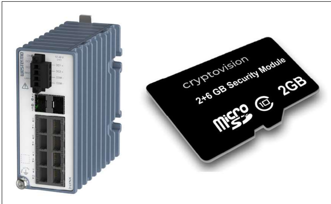
Bild 1: Das eingesetzte Krypto-Netzwerk-Modul (links) wird mit einem HSM im microSD-Format (rechts) betrieben. Das HSM ist austauschbar, wodurch unter anderem neue Krypto-Algorithmen eingespielt werden können.
